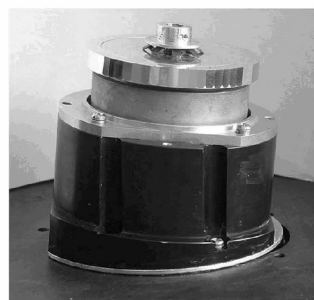
图 3 可实现二维扫描的扫描转镜
